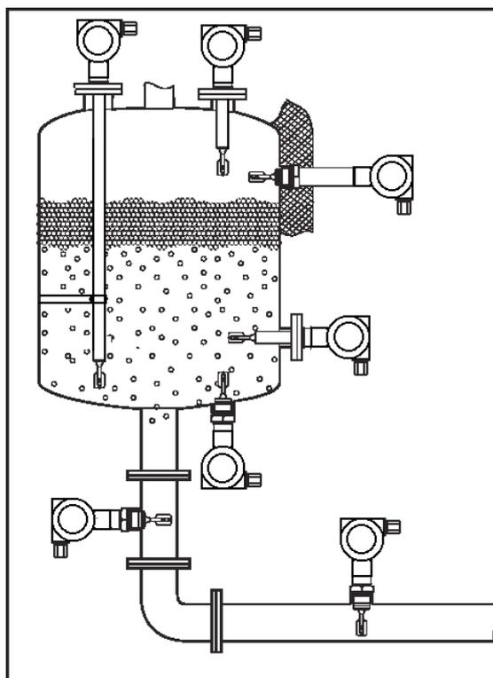
Рисунок 6. УСТАНОВКА ВИСУР С ЗАЩИТНОЙ ТРУБКОЙ
