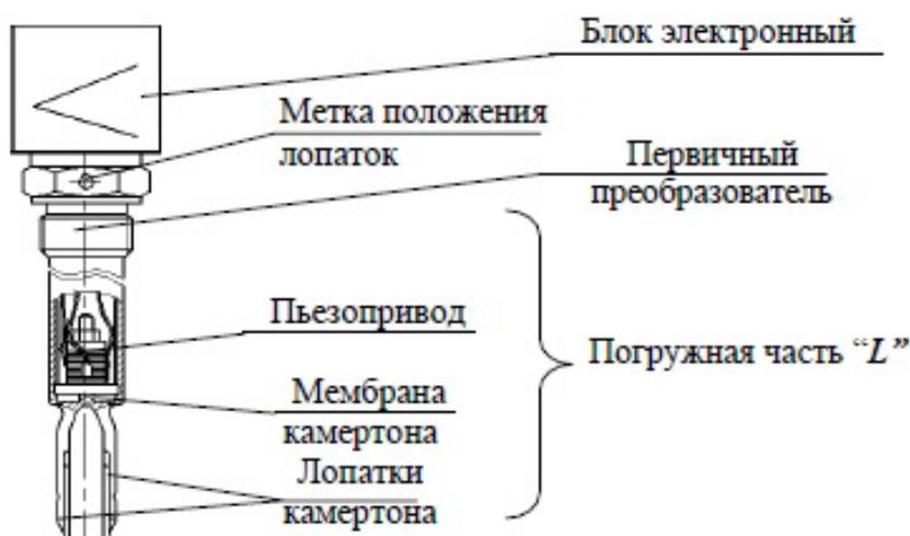
4.1.2 Первичный преобразователь представляет собой корпус в виде трубки из нержавеющей стали, с закрепленным в нем пьезоэлементом, который жестко соединен с вибрирующим камертоном, состоящим из мембраны и лопаток.
