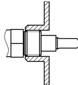
10.4 При установке в емкости и трубопроводы лопатки ВИСУР должны полностью выступать внутрь и ориентироваться вертикально (см. рис. 8).
